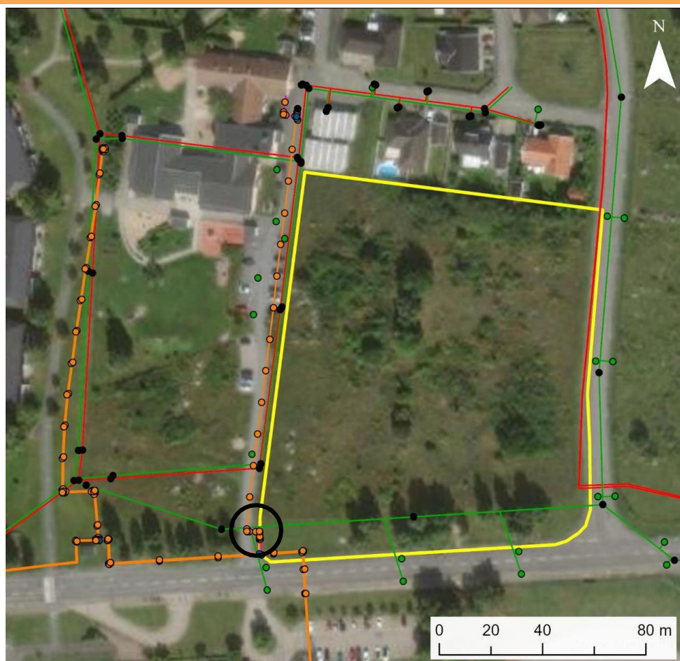
Figur 6. Bevab:s ledningar, däribland dagvatten-, spill- och fjärrvärme kring planområdet (gröna, röda och orange linjer). Svart, cirkel markerar lämplig anslutning till dagvattennätet. Gul linje är planområdets gräns.
